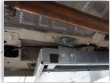
Kabel in der B-Säule hochbringen
